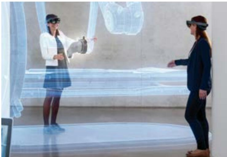
Schon während der frühen Entwicklungsphase lässt sich die Funktionalität von Produkten mit Hilfe der HoloLens noch vor den ersten Prototypen beurteilen.
