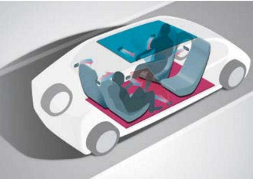
Die Klimatisierung erfordert neue Lösungen, insbesondere in der Positionierung der Ausströmer.
