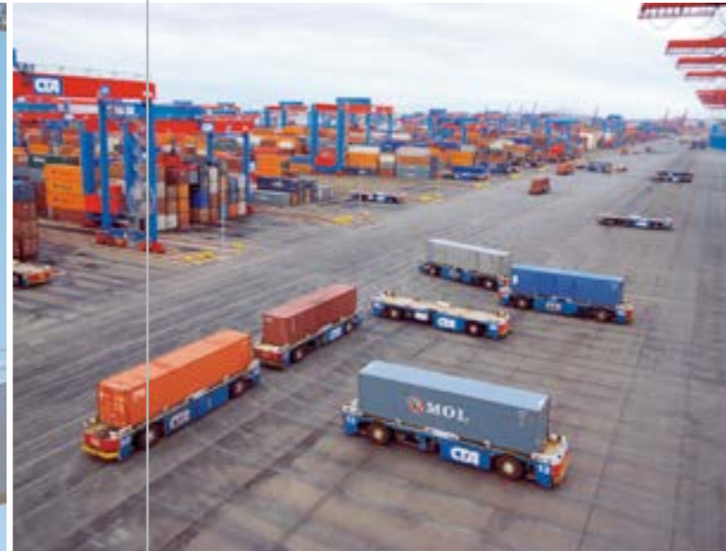
Automated Guided Vehicles übernehmen den Containertransport mit bis zu 6 m/s.
