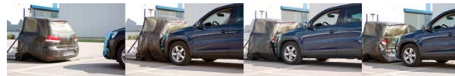
Stau-Ende-Szenario: Versuchsablauf mit vorgeformtem Target.
