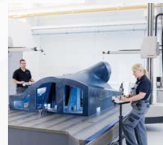
Dokumentation mit CNC-Messtechnik.
