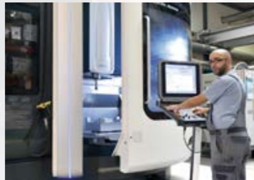
Spritzguss-Werkzeuge mit modernster Technologie fräsen – die DMU 105.
