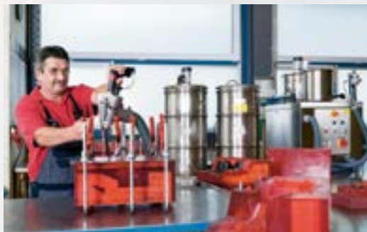
Niederdruck-RIM: Teile für einfache Funktionsprüfungen aus Nicht-Serienmaterialien.
