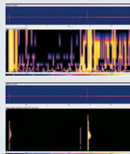
Darstellung einer FFT-Analyse (oben) und einer Relative Approach Analyse (unten).
