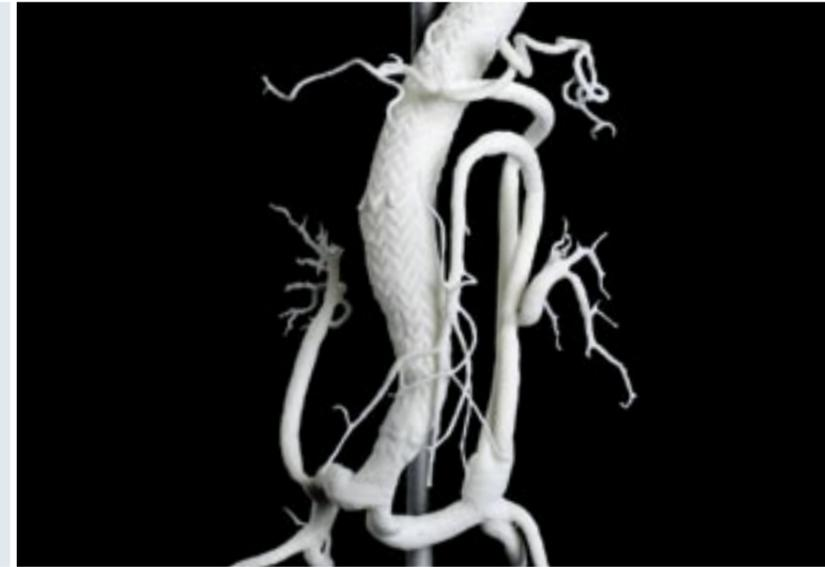
Das Lasersinter-Verfahren stellt die originalgetreue Abbildung von komplexen Modellen und filigranen Blutgefäßen sicher.
