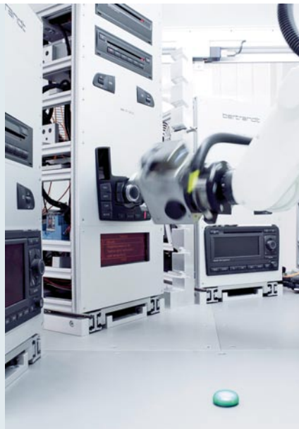
Einsatz von Robotern zum Testen von Infotainment-Komponenten.
