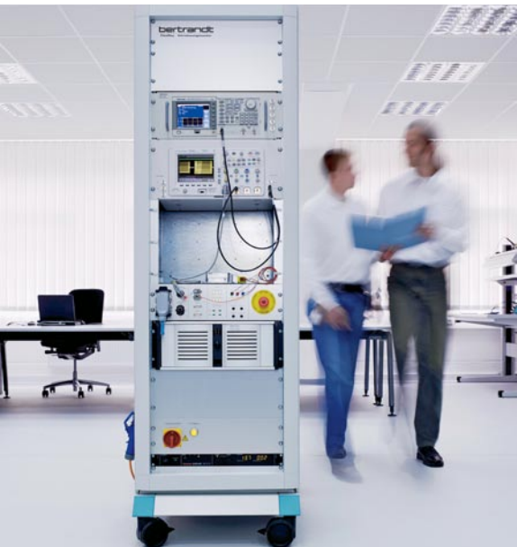
Komplexe Prüf- und Testsysteme, hier der FlexRay-Vernetzungstester.
