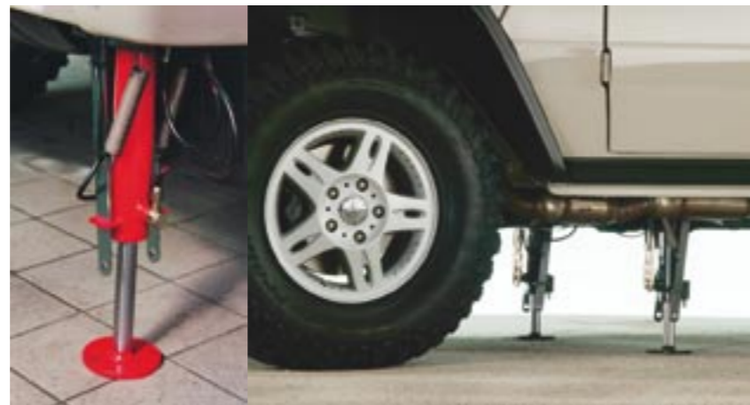
Gegen Wanderdüne gerüstet: Für sicheren Stand sorgen vier ausfahrbare Hubstützen.
