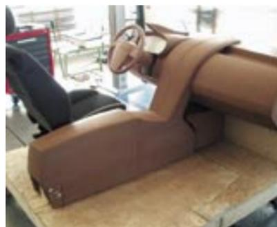
Projekte bis hin zum sogenannten „Mock-up“, einer skeletthaften Darstellung eines kompletten Fahrzeugs samt Innenraumkomponenten.
