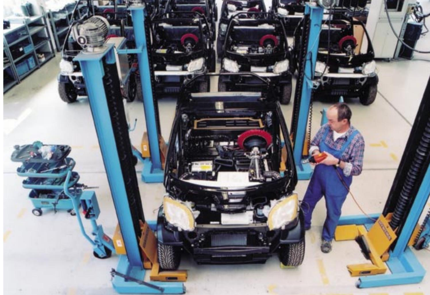
wurden. Dazu zählte auch das Werkzeugcontrolling, die Überwachung der Werkzeugherstellung, die Erfassung benötigter Bauteile sowie die Koordination des Zusammenbaus ganzer Baugruppen – einschließlich der Sicherstellung der Kleinserienfertigung beim Partner Binz. Hier wurde und wird der smart crossblade in einer limitierten Stückzahl von 2000 Exemplaren montiert.
