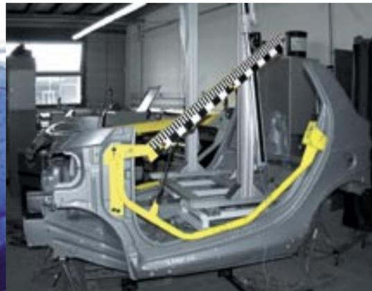
Türbalkendauerlauf auf dem eigens hierfür entwickelten und gebauten Sonderprüfstand.
