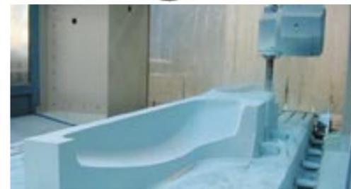
Die Seifenkiste wurde in einer ausschließlich virtuellen Umgebung entwickelt. Auf einer 5-Achs-Fräse entstand die Form für das Monocoque.
