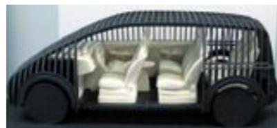
1:4 Foamcoremodell zur Darstellung eines variablen Interieurkonzeptes.
