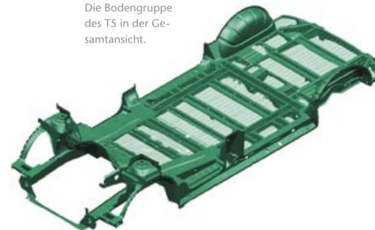
VPM-System, das speziell auf die VW-Anforderungen abgestimmt ist, werden komplexe Fahrzeugentwicklungsprozesse entscheidend verbessert. Ein Highlight ist hierbei die virtuelle Absicherung von Vorderwagen, Plattform und Gesamtfahrzeug.
